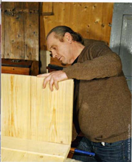
Nur bei den Verbindungen muss Stephan Mühlbauer einen Kompromiss eingehen: Nut und Feder verhindern, dass das Holz reißt.
