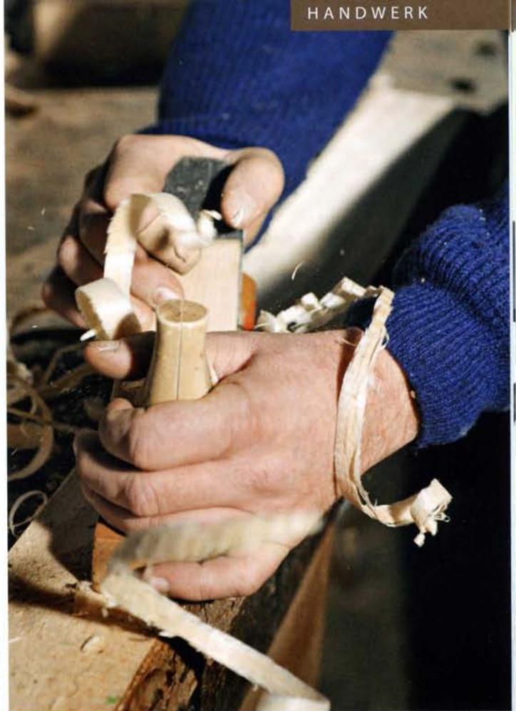
Um die richtige Optik zu erreichen, arbeitet der „Kistler“ wie einst seine Vorgänger nur mit dem Schrupphobel.
